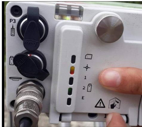
Figura 1. Verificación de las luces del receptor
