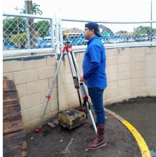
**Figura 12. Nivelación de la Estación REMOS Barquisimeto.**
