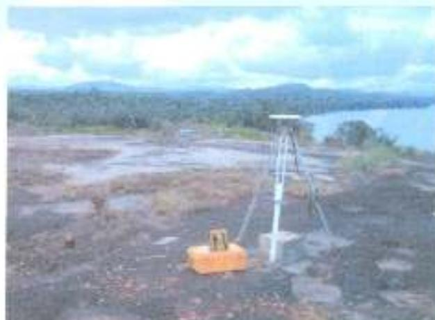
**ACCESO:** El vértice se encuentra ubicado en la vía de acceso al Puerto de Morganito, específicamente en la loma mas alta de la piedra que se encuentra al lado derecho de esta vía. Es un monumento de concreto de 30x30 y sobresale del terreno 30 cm., con una placa de bronce de  $\pm 2.5$  cm. de radio.
