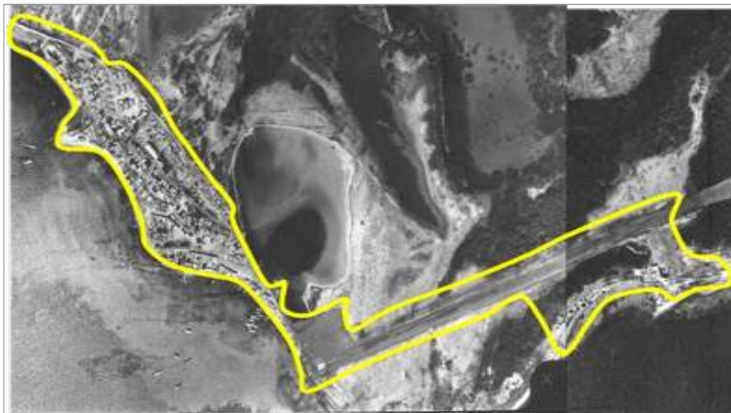
*Fig. 1.- Vista en planta del establecimiento del control geodésico para el levantamiento topográfico del poblado Gran Roque, Archipiélago Los Roques.*
