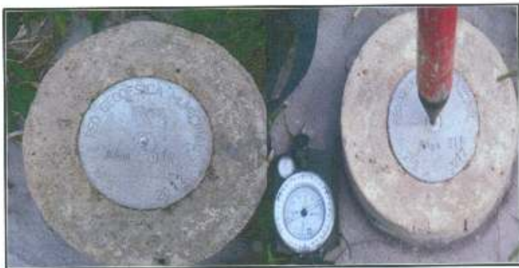
Figura 7: Monumentos. Colocación de monolitos de concreto
