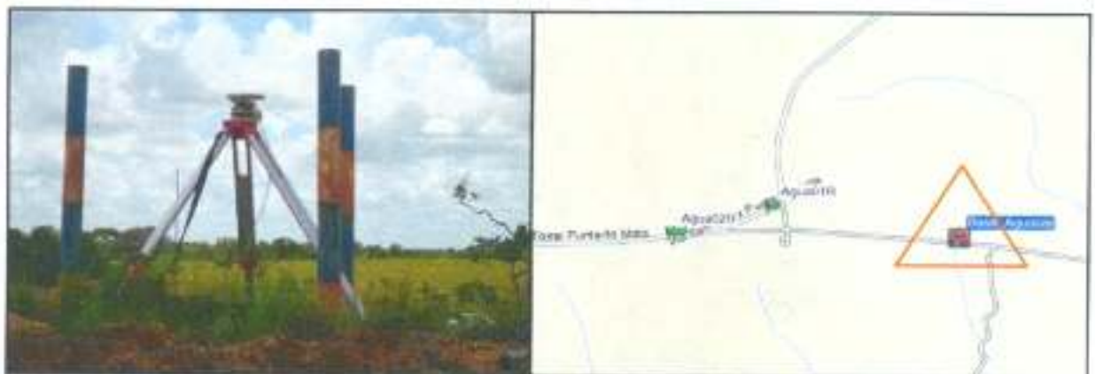
Figura 3: Vértice de vinculación al Sistema Geodésico Nacional (RGM 01)
